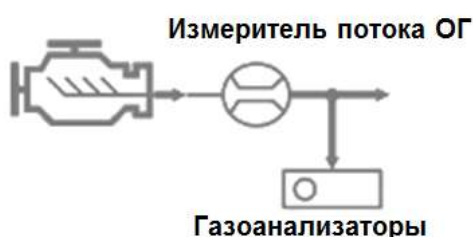
Рис. 33. Упрощённая схема системы отбора проб непосредственно из потока ОГ (Источник: фирма AVL)
