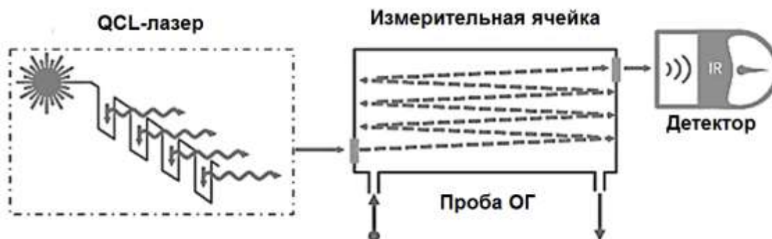
Рис. 42. Схема системы QCL для измерения концентрации азота закиси N_2O и аммиака NH_3 (Источник: фирма AVL)
