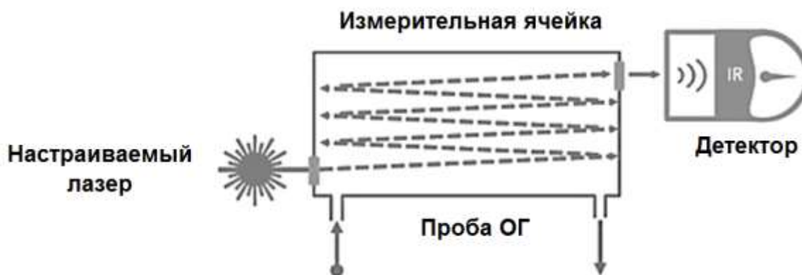
Рис. 43. Схема системы LDD для измерения концентрации аммиака NH_3 (Источник: фирма AVL)
