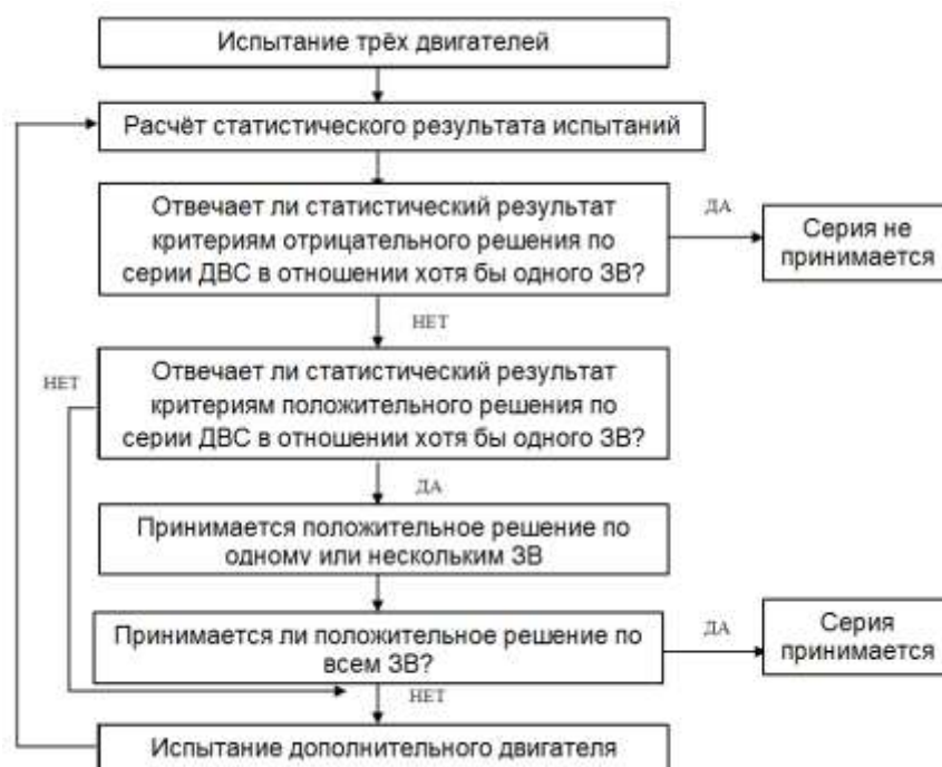
Рис. 21. Процедура испытаний серии ДВС на соответствие производства
