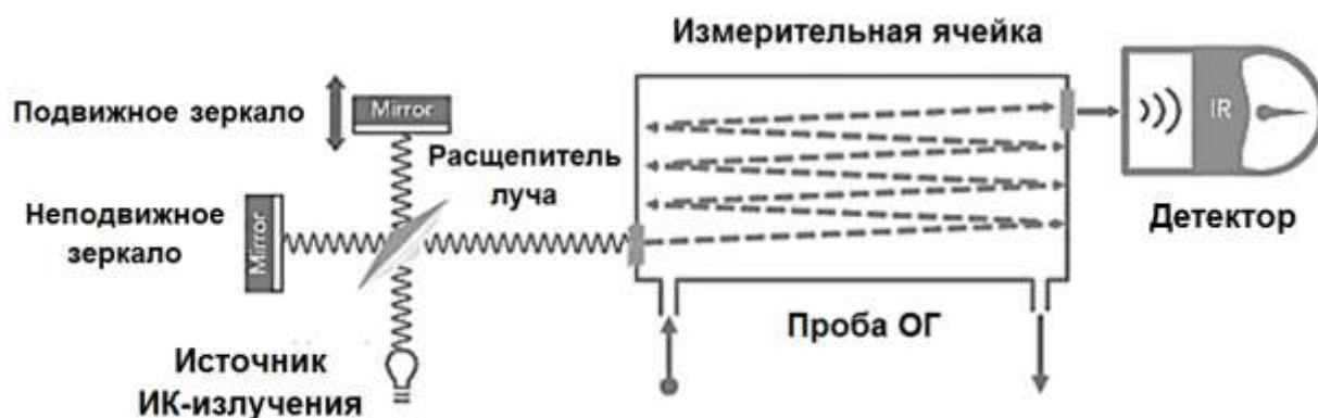
Рис. 44. Схема системы FTIR для анализа многокомпонентной газовой смеси (Источник: фирма AVL)
