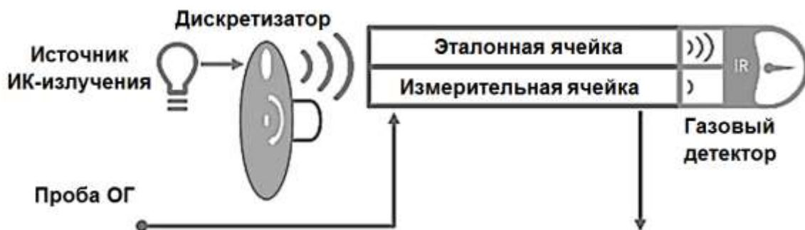
Рис. 40. Схема системы NDIR для измерения концентраций \text{CO} и \text{CO}_2 (Источник: фирма AVL)
